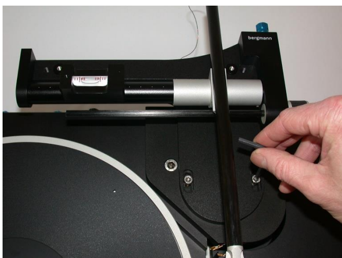
(左図) 2 x 5 mmネジを緩め又は締め付けてエアパイプが完全に水平になるまで調整します。水準器を使用して調整します。(写真左)
