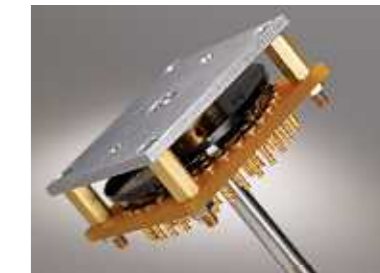
カスタムメイド銀接点ロータリースイッチが高い信号精度を達成。
