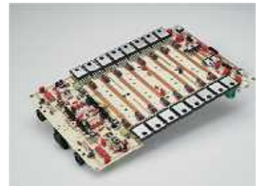
フル・ディスクリート仕立てのオーディオ回路。NPN/PNPの4ペアをホット・コールドに、計16個のThermalTrakバイポーラ出力トランジスターを搭載。
