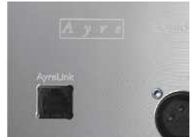
RJ-11モジュラーコネクタによるAyreLinkターミナル。
