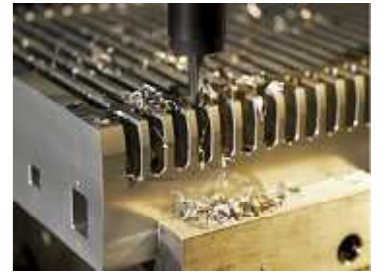
プレジジョン・コンピューターコントロール・ミリングマシンによる精巧な削りだし加工。絶対的な三次元精度を生み出します。
