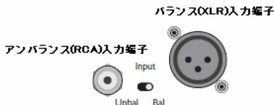
使用する入力端子に合わせてリアパネルのスイッチを切り替えてください。
