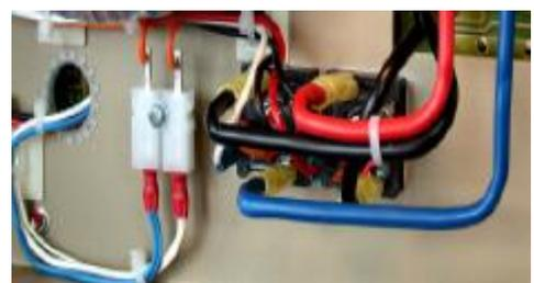
●シャーシー下部、デュアル整流器と厳格な手加工による端末・配線処理によって高速・大電流パワーサプライを実現。
