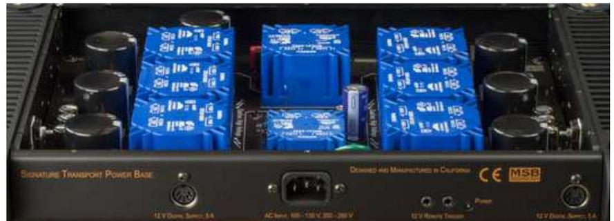
アップグレード・パワーベース 2 機種は、リニア方式の採用によって超低ノイズで極めて安定した強力な電源供給を実現。本体と同サイズにしてバランスよくスタックすることもできます。
