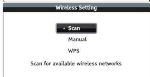
・Scan : 利用可能な無線ネットワークをスキャンします。上下矢印ボタンでネットワークを選びエンターボタンで選択確定します。必要に応じてセキュリティーキーを入力します。
