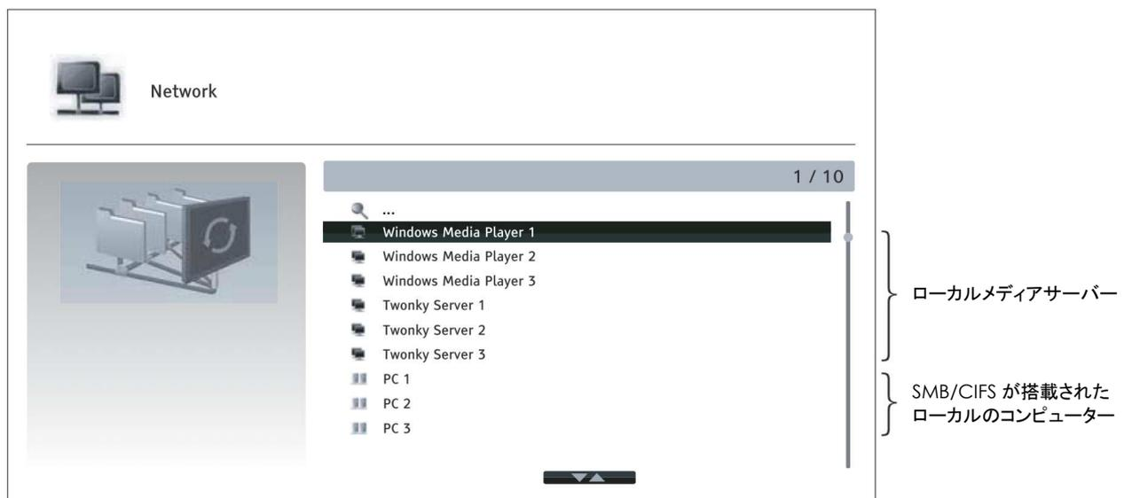
本機はLAN接続されたホームネットワーク内にあるDLNAあるいはSMB/CIFS(ネットワーク共有プロトコル)に対応したPCやNASなどのメディアデバイスに保存され共有設定された音楽、写真、ビデオなどのメディアをリモート再生することができます。また、本機はDMR(デジタルメディアレンダラー)としてiPadなどからのDMC(デジタルメディアコントローラー)によるコンテンツ再生にも対応します。
