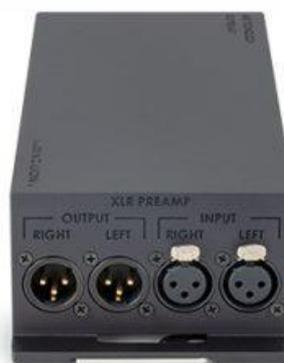
※もしどうしても、既存のプリアンプを Select DAC の出力の後に接続しプリアンプ側でボリュームコントロールする必要がある場合は、本機のボリューム設定を 94 としてください。最もノイズレベルが低い状態で、かつ、プリアンプのクリッピングも防止できます。
