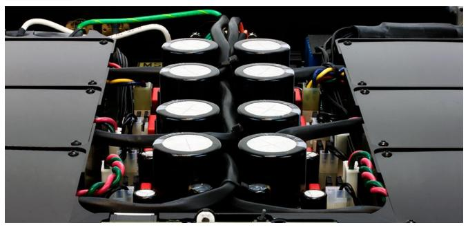
SELECT DAC, REFERENCE DAC の標準電源ユニットは、"The Dual Powerbase"。本体と同サイズで、スタックしてバランスよく配置することのできる専用のセパレート電源です。整流・定電圧回路構成は、余計な高周波ノイズを放出しないアナログ・リニア仕立てとし、整流素子には超高速シリコン・カーバイド・ショットキー・ダイオードを採用。真空管動作に近いこの素子は、高効率で大電流を安定して取り出せると同時に、ターンオン/オフの瞬時性に優れ、一般の整流素子につきもののオフ時のリカバリー逆電流の発生とそれに起因するノイズを大幅に低減させています。
