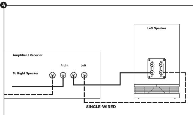
シングルワイヤー接続の場合は、ジョイントバーを外さずにケーブルの - を LF か HF のいずれかの - 端子に、ケーブルの + を LF か HF のいずれかの + 端子に繋ぎます。 →FIG 4
