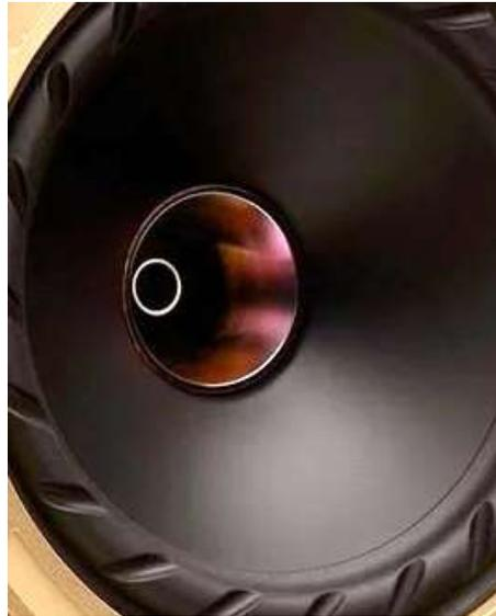
低域ポートをエンクロージャーの底に下向きに配し、その開口部に垂円錐状のディフューザーを設けるといふ、この独自システムは、ポートから発する垂直プレーン波エネルギーを 90°向きを変えて 360 度の水平波に変換。低域の放射特性を圧倒的に改善し、クリアで力強い低域再生を、設置場所の制約を受けることなく実現します。
